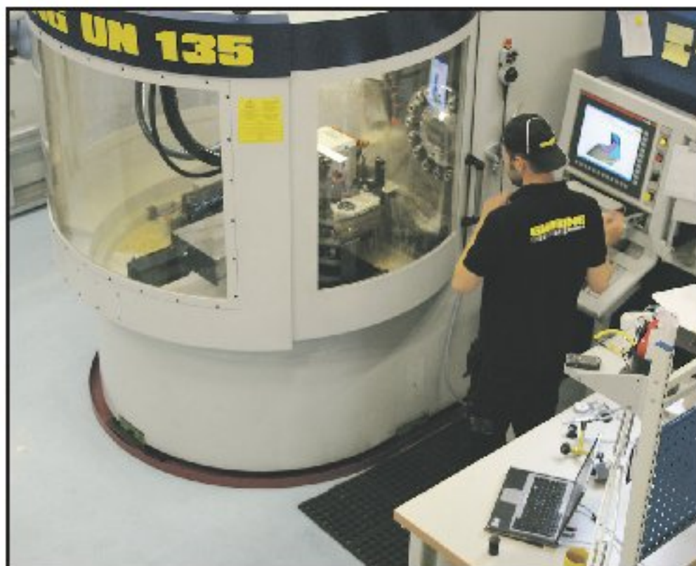
Gühring fremstiller selv slibemaskiner som denne UN 135. Disse maskiner kan kun anskaffes af virksomhedens egne sliberter og anvendes at have en nøjagtighed på 0,001 millimeter. Maskinen er udstyret med en Siemens-styring, og er i øvrigt omgærdet med megen hemmelighed.
